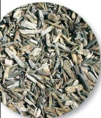
GRANULATS LÉGERS DE BOIS traités par enrobage de liant hydraulique, spécialement adaptés à la fabrication en centrale à béton (BPE) ou pour la préfabrication d'éléments en béton.
